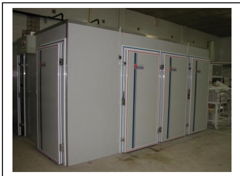
Dos cámaras de 10 carros cada una en un mismo mueble. Puertas en ángulo recto
