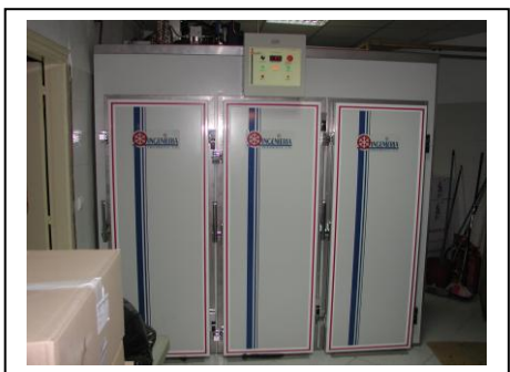
Cámara de tres compartimentos, cada uno para 2 carros de 0,50 m x 0,70 m
