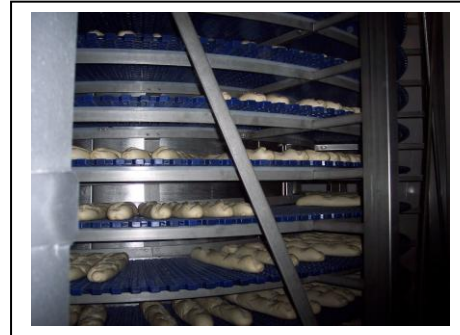
Carrusel acoplado a una línea de 2.000 piezas/hora de 300 gr cada una
