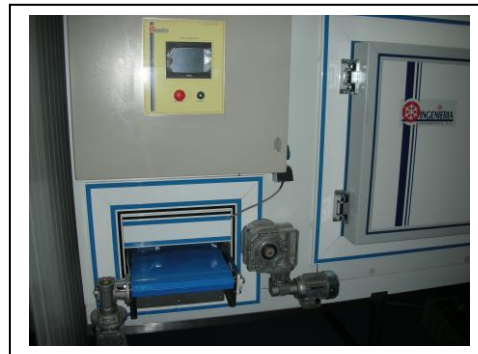
Túnel para ultra congelación de 300 kg/h de croquetas
