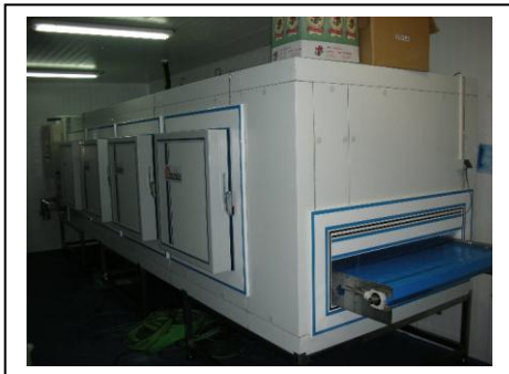
Túnel para ultra congelación de 300 kg/h de croquetas
