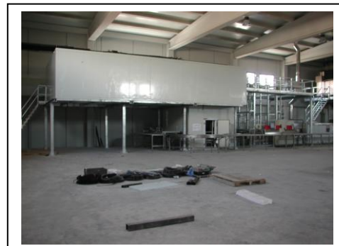
Túnel tipo noria para 4.200 piezas/hora de 300 gr.
