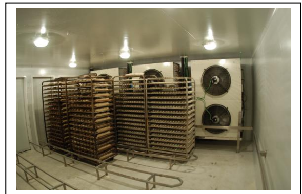
Interior de túnel para 1.000/1.100 kg/h Diseño adaptado a las dimensiones del local. 1 puerta de entrada y cuatro de salida
